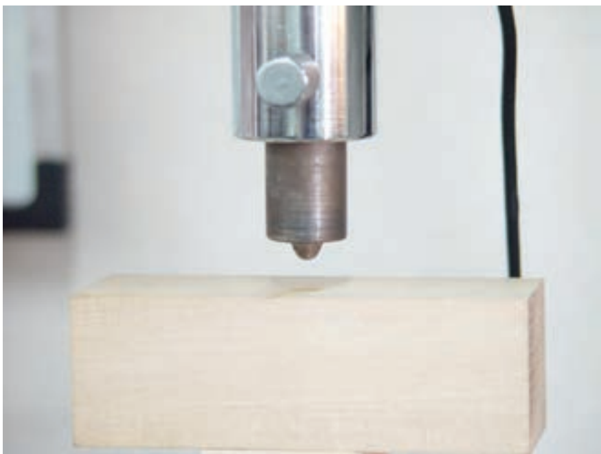
شکل ۱۱-۱- شمای وسیله سنجش سختی چوب
