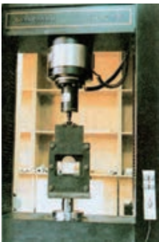
شکل ۲-۱۰- طرز قرار گرفتن نمونه چوب در دستگاه آزمایش
