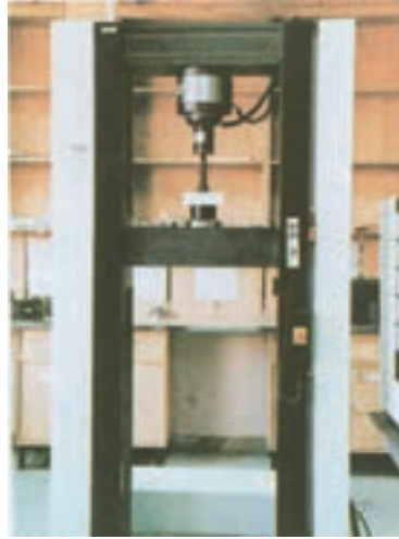
شکل ۲-۱۱- نحوه آزمایش سختی در دستگاه
