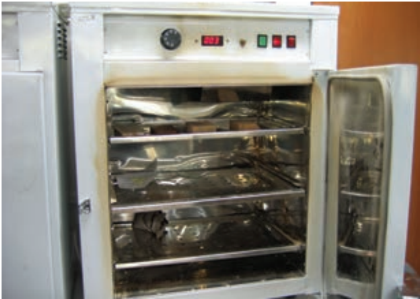
شکل ۳-۵- نوعی اتو ۲ برای خشک کردن چوب
