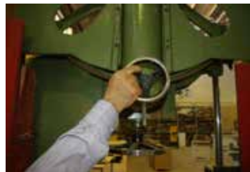
شکل ۷-۲- تنظیم لبه‌ی تیغه اره با لبه‌ی فلکه توسط فرمان مربوطه.
