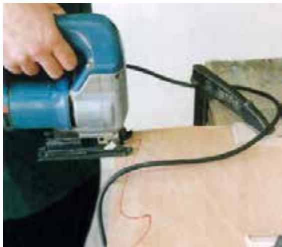
شکل ۲۹-۱۵- قبل از شروع برش، سیم برق را در پشت دستگاه قرار دهید.
