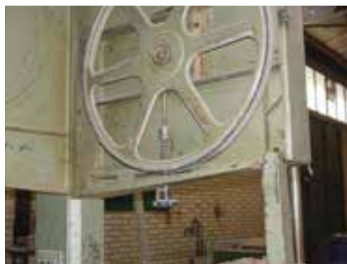
شکل ۱۹-۳- میله ی مارپیچ فلکه، همواره باید تمیز و گریس کاری شده باشد.
