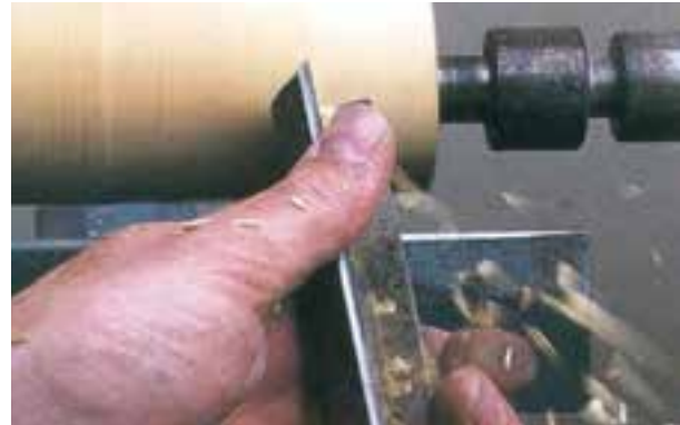
شکل ۱۱-۵۰- گرد کردن نهایی چوب با مغار گلوبی.
