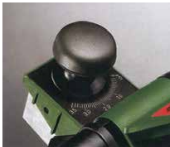
شکل ۴- ۱۴- پیچ تنظیم صفحه برای پوشالبرداری
