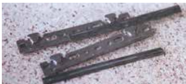
شکل ۱۰-۱۴- وضعیت تسمه و چگونگی نصب آن روی توپی. به اهرم بالای تسمه توجه کنید.
