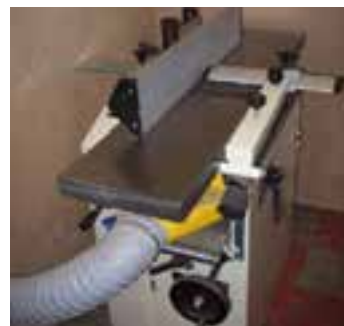
شکل ۴-۲۲ - مکنده‌ی قابل اتصال به ماشین کفرند.
