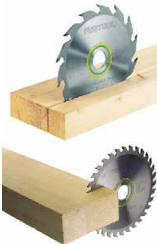
شکل ۱۲-۹ برش طولی و عرضی یک چوب سوزنی برگ.
