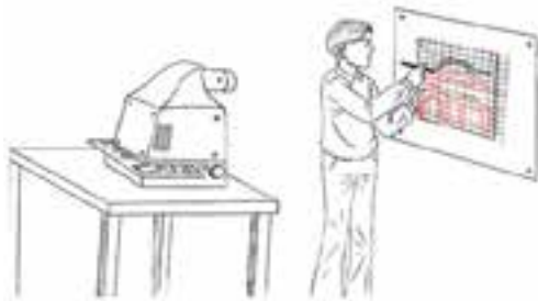
شکل ۱۶-۱۸. استفاده از پروژکتور اوپک برای بزرگنمایی.
