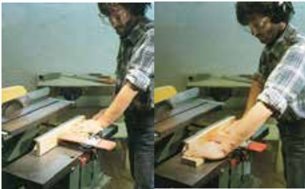
شکل ۱-۴۴-۱- گونیایی کردن چوب قبل از برش.
