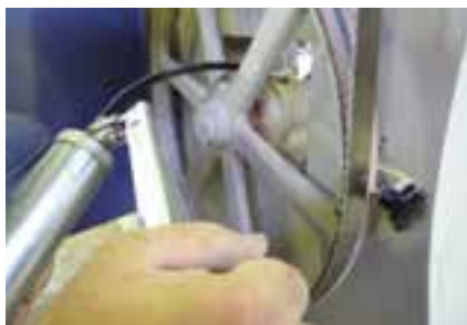
شکل ۳-۳. گریس کاری کتو جابجایی فلکه‌ی بالا.
