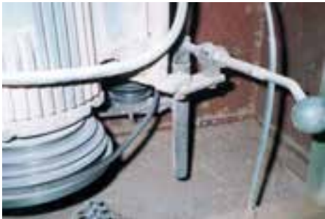
شکل ۳-۱۵. اهرم الکتروموتور، آزاد است.
