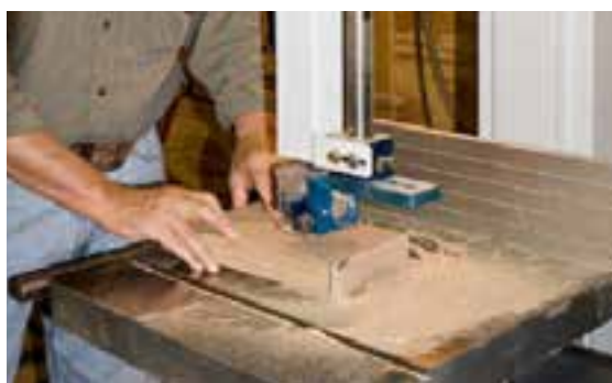
شکل ۱-۳۵-۱. فاصله‌ی ارتفاع سطح چوب با دستگاه هدایت.
