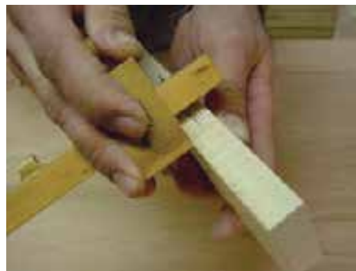
شکل ۹-۱۵- تعیین وسط نر چوب به‌وسیله‌ی فطکش تیره‌دار.
