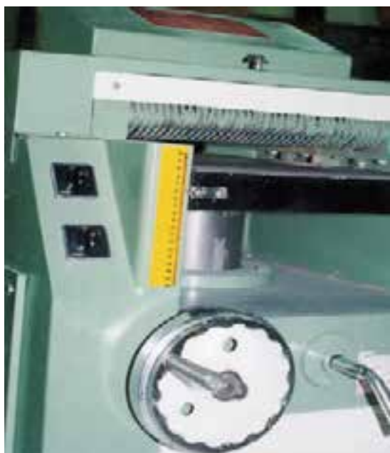
شکل ۴۱-۷- این ماشین، به دو کلید مجهز است.
