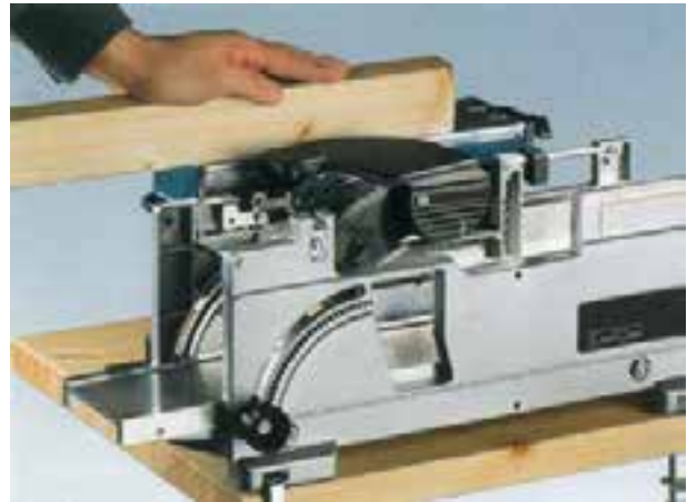
شکل ۱۴-۲۰- کاربرد میز کمکی در موقع رندیدن.
