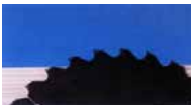
بیرون زدگی تیغه، مناسب است.
