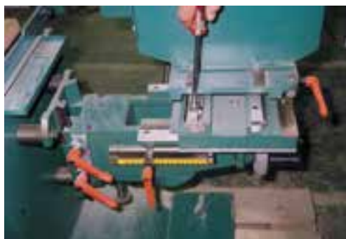
شکل ۱۰-۲۱ - سفت کردن پیچ‌های شُل شده.
