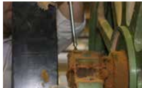
شکل ۳-۱۳. گریس کاری یاتاقان فلکه اره.
