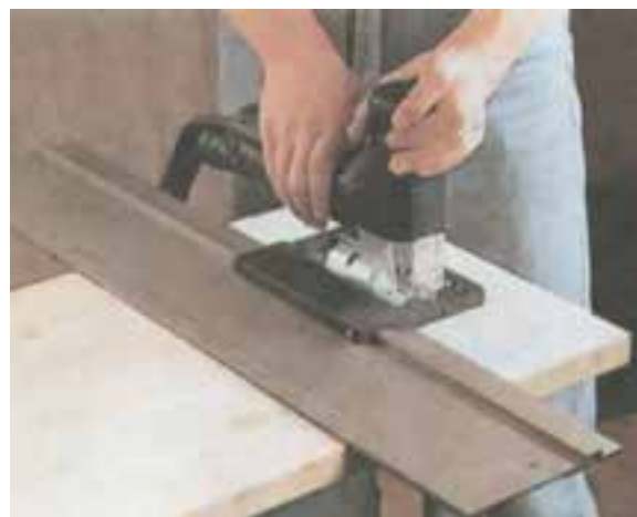
شکل ۱۵-۲۰- برش عرضی چوب به کمک ریل راهنما.
