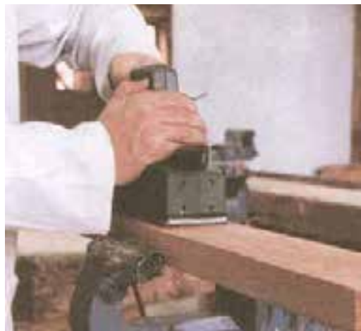
شکل ۱۷-۱۴- نمونه‌ی بستن چوب داخل گیره
