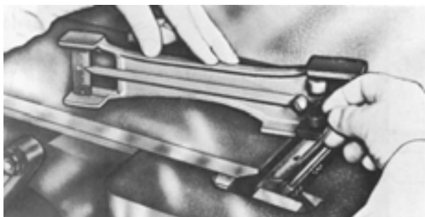
شکل ۹-۵- تنظیم ارتفاع تیغه رنده نسبت به صفحه‌ی فروچی.
