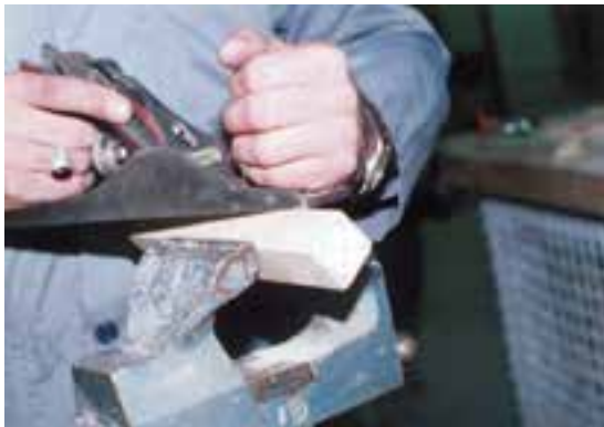
شکل ۱۱-۵۳- مراحل آماده‌سازی چوب برای فرایندی کردن.
