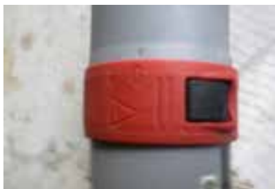
شکل ۱۷-۷ - کلید قطع و وصل دستگاه فرز بیسکوییتی
