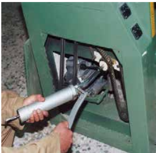
شکل ۸-۷- گریس‌کاری ممورهاى انتقال نیرو.
