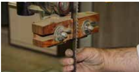
شکل ۳-۱-۱- کنترل‌های لازم تیغه قبل از کار.
