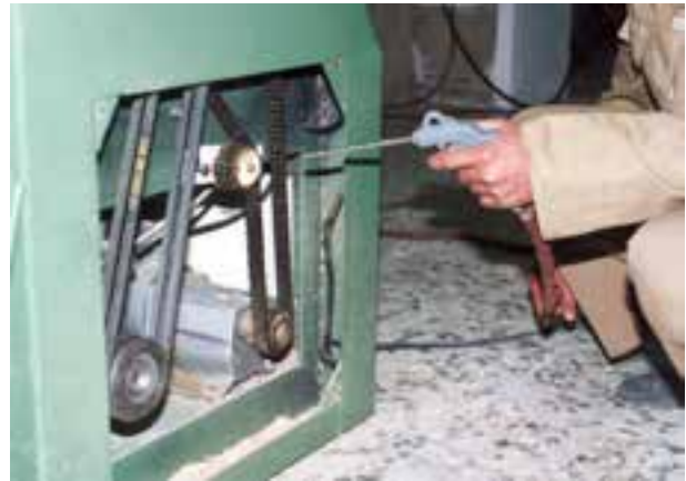
شکل ۸-۱۵- بادگیری داخل قسمت انتقال نیرو.
