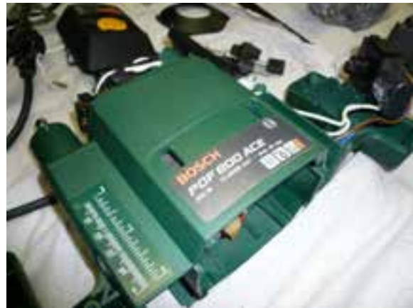
شکل ۱۶-۹- بدنه یا جلد دستگاه اورفرز.
