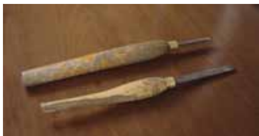
شکل ۱۱-۲۰- نمونه‌ای از مغارهای با دسته‌ی معیوب.
