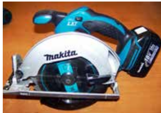
شکل ۱۳-۱- ماشین اره گرد دستی - شارژی.
