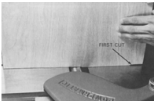
شکل ۴-۲۵ - پله شدن چوب.
