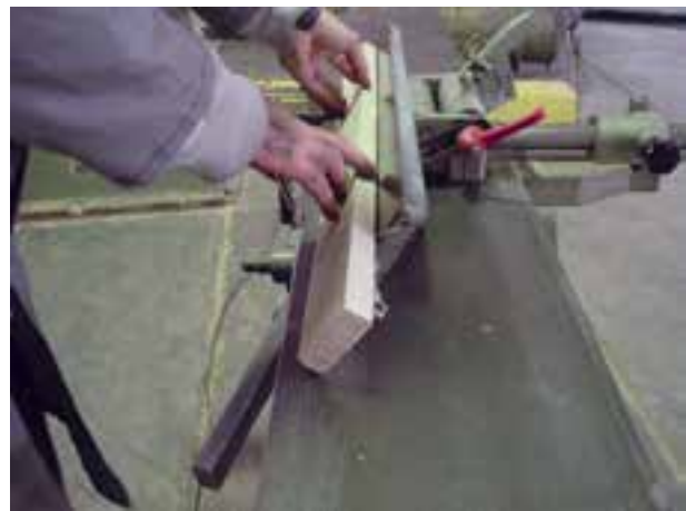
شکل ۳۵-۴- رنده کردن نر چوب با زاویه ۴۵ درجه.
