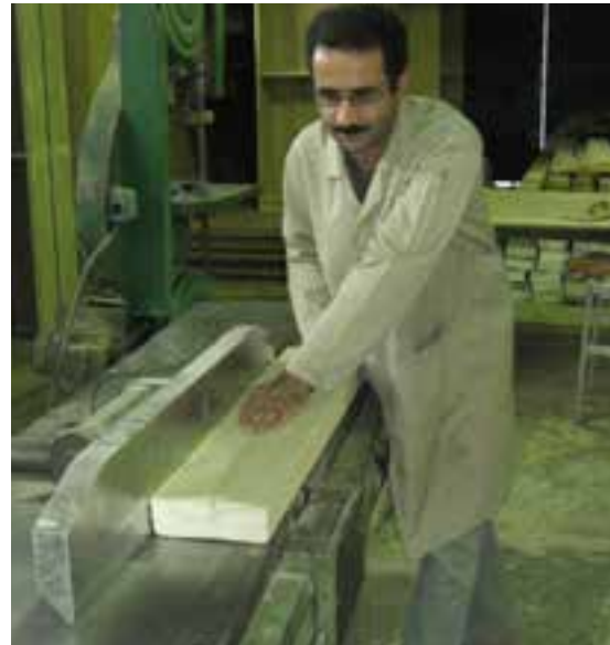
شکل ۱۶-۴- طرز ایستادن صحیح در کنار ماشین.
