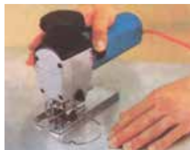
شکل ۱۵-۲۵- دایره‌بُری بدون گونیا (ممل دایره قبلاً با پرگار مشخص شده است).
