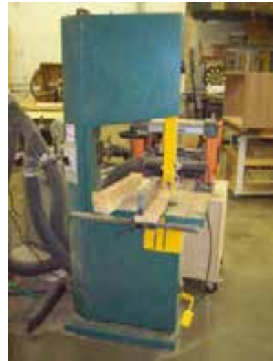
شکل ۹-۱- یک ماشین اره‌نواری، با حفاظ کامل.
