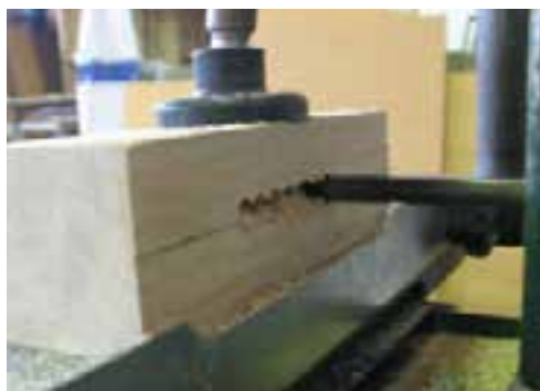
شکل ۹-۳۸ - برداشتن فاصله‌ی دو سوراخ.
