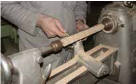
شکل ۱۱-۵۶- نمونه علامت‌گذاری و تعیین اندازه
