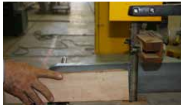
شکل ۵۴- ۱- نمونه‌ی برش با اره‌نویاری.
