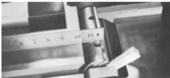
شکل ۱۲-۵- ثابت کردن توپی رنده با یک قطعه چوب در کنار توپی.
