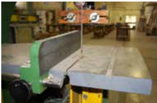
شکل ۱۲-۱- گونیا ثابت یا طولی.
