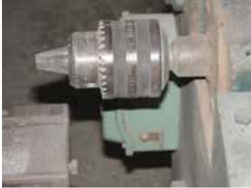
شکل ۹-۵ - سه نظام در ماشین گُم‌کنی.
