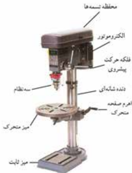
شکل ۱۹-۴- دریل ستونی پایه‌دار و قسمت‌های آن.
