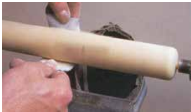
شکل ۱۱-۳۵- به وسیله‌ی سناده‌ی زبر، چوب فرامی‌گردد.
