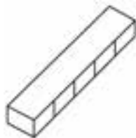
شکل ۹-۳۰- تقسیم نر چوب به ۵ قسمت مساوی.
