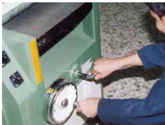
شکل ۷-۳۴ - تنظیم مقدار بار گندگی.
