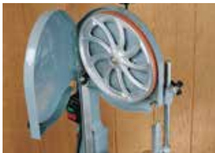
شکل ۲-۴. حفاظ باز شده‌ی روی فلکه و تیغه.
