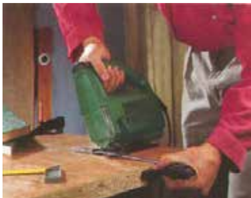
شکل ۱۵-۲۲- نمونه‌ی برش تحت زاویه به کمک گونیا و اره پکشی.
