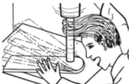
شکل ۱۹-۲۶- درگیر شدن مته با موی سر.
