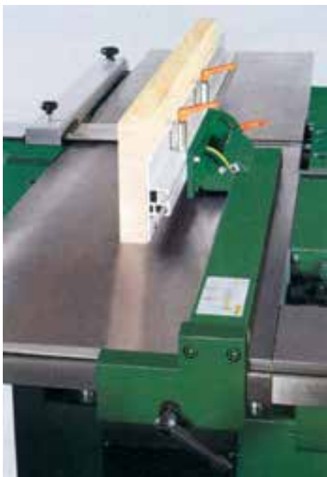
شکل ۶-۴- یک نوع گونیای متمرک و متصل به ماشین رنده.
