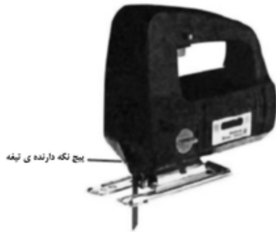
شکل ۱۶-۱۵- پیچ نگه‌دارنده‌ی تیغه.
