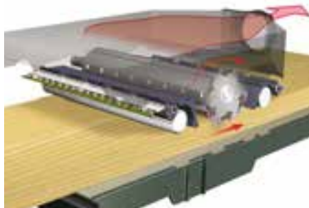
شکل ۸-۷- غلتک آبدار، توپی تیغه‌ها و غلطک صاف.
