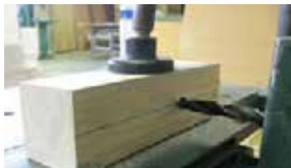
شکل ۹-۱۸- تنظیم نیش مته با قط وسط چوب.
