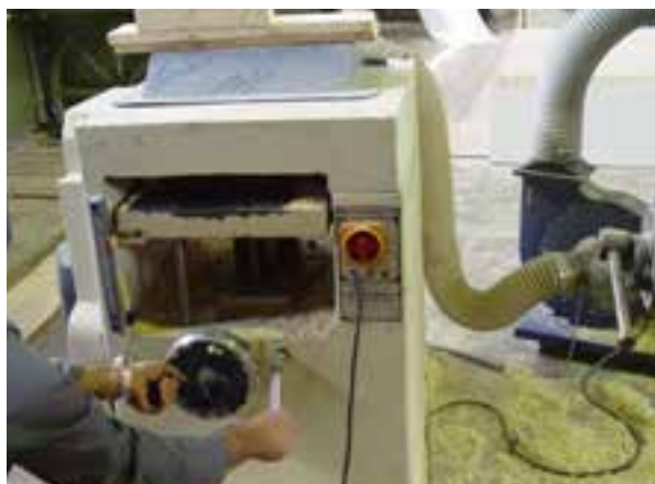
شکل ۴۰-۷- تنظیم دهانه‌ی گندگی.
