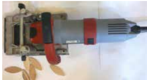
شکل ۱-۱۷- دستگاه فرز بیسکویتی، به همراه تعدادی زبانه‌ی بیسکویتی.
