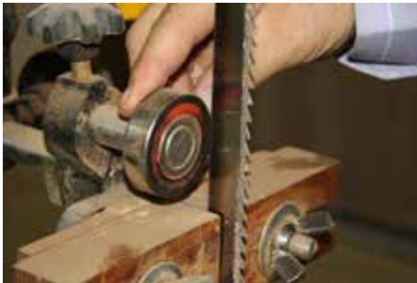
شکل ۳۰-۱ کنترل بلبرینگ پشت تیغه.
