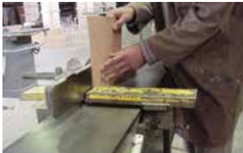
شکل ۱۸-۴- استفاده از حفاظ تیغه در رندیدن چوب‌های با ضخامت کم.
