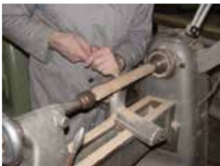
شکل ۱۱-۶۱- گرد کردن کامل قطعه چوب هشت ضلعی.
