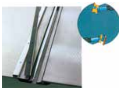
شکل ۱۵-۱۴- توپی (میله‌ی رنده) و تیغه‌ها.
