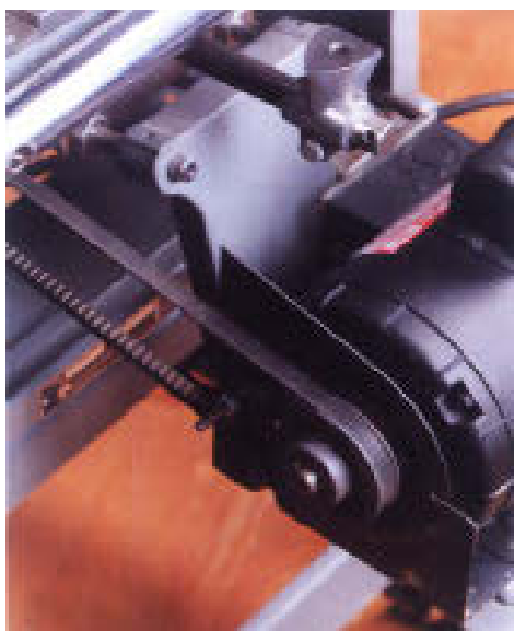
شکل ۱۲-۳۳- تسمه‌ی انتقال نیرو و حرکت.
