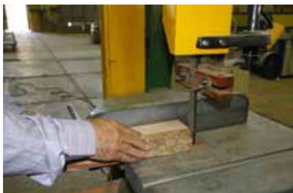
شکل ۱-۳۶-۱. برش با اره پس از یک رو و یک نر کردن.
