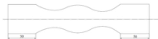
شکل ۱۱-۵۸- نمای قطعه چوب پس از عملیات فراطی.
