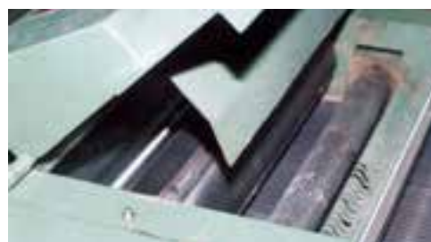
شکل ۱۲-۷. حفاظ توپی تیغه‌ها و غلتک‌ها
