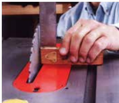
شکل ۱۲-۲۲- کنترل و تنظیم گونیا‌یی بودن تیغه.
