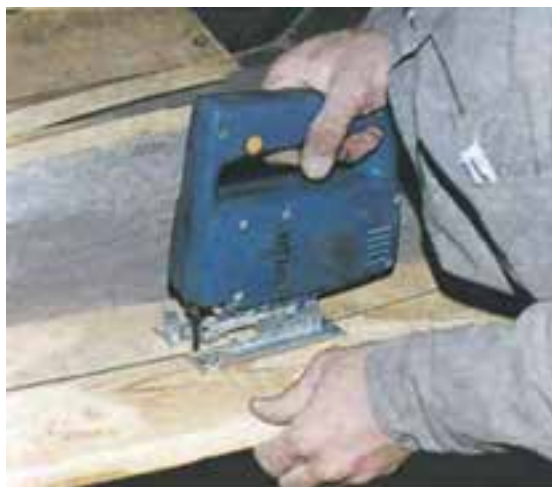
شکل ۱۵-۱۹- برش طولی چوب بدون استفاده از گونیا.
