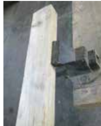
شکل ۲۸-۱۴- بستن قطعه چوب به گیره.
