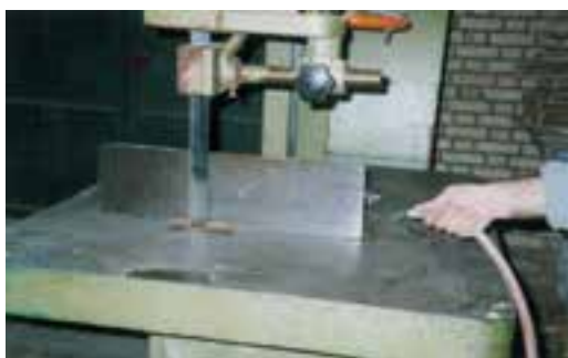
شکل ۱۸-۳- نظافت و گردگیری پس از پایان کار.
