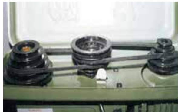
شکل ۱۹-۱۳- تغییر دور پله‌ای در دستگاه دریل ستونی.
