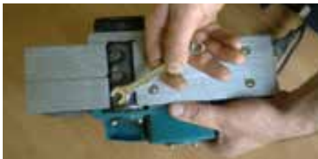
شکل ۱۴-۲۳- خارج کردن تیغه‌ها از جایگاه.
