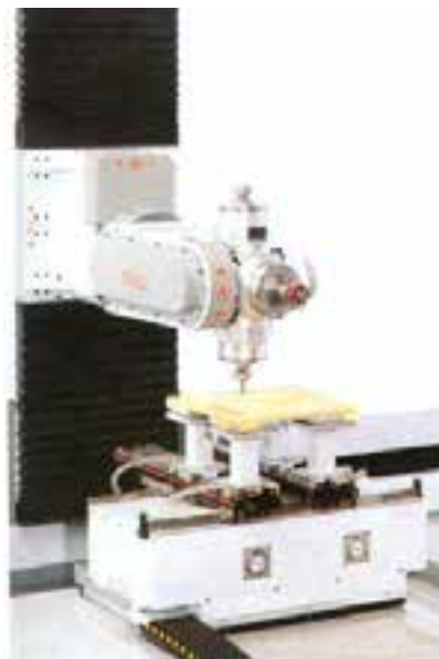
شکل ۸- دستگاه C.N.C برش بر روی چوب.
