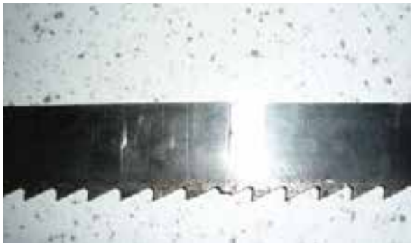
شکل ۱-۷۰- ترک تیغه اره از ممل جوش.
