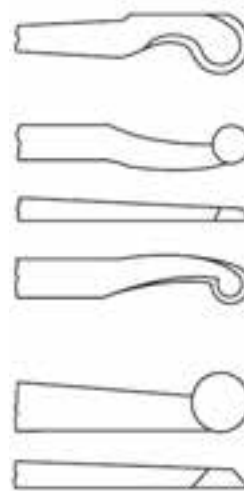
شکل ۱۱-۱۷- مغارهای مخصوص سطوح مقعر و فضاهای داخلی.
