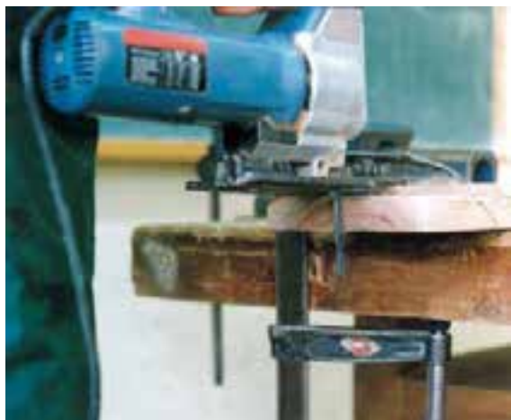
شکل ۳۵-۱۵. صفحه، کاملاً روی چوب قرار نگرفته است.
