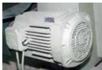
شکل ۵-۱۱- الکتروموتور سه‌فاز یک ماشین خراطی.
