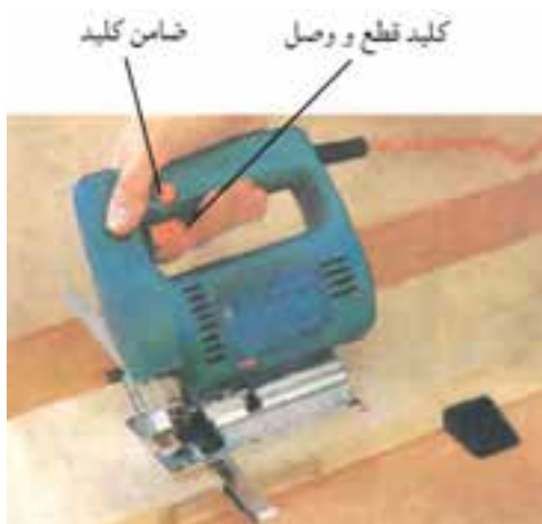
شکل ۴-۱۵- کلید قطع و وصل و ضامن کلید.
