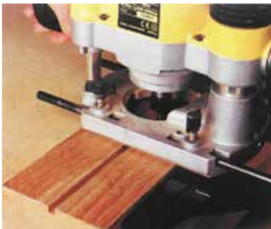
شکل ۱۶-۳- کنشکاف زدن، با دستگاه اور فرز.
