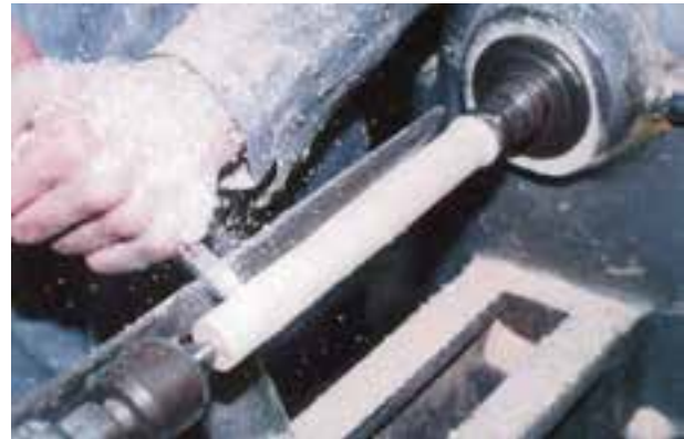
شکل ۱۱-۶۲- یکنواخت کردن چوب.
