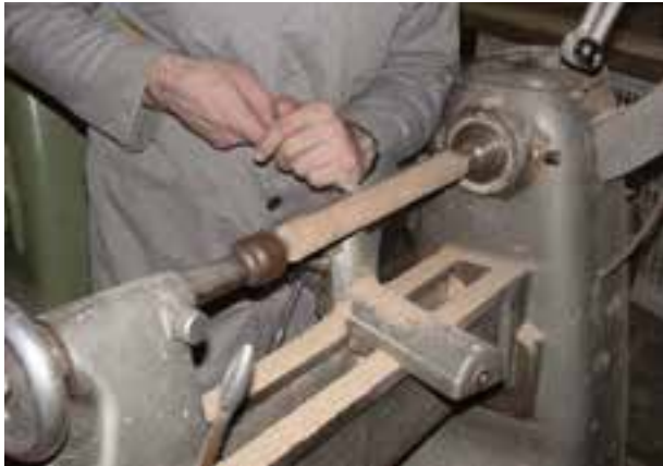
شکل ۱۱-۲۷- نمونه‌ی قرار گرفتن مغار گلوبی هنگام فراطی.
