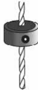
شکل ۱۹-۵۳- قطعه به‌جای میله‌ی عمق سنج.
