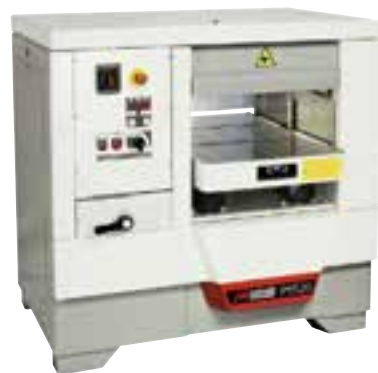
شکل ۱۱-۷- غلتک‌های صاف پایینی در گندگی‌های بزرگ.
